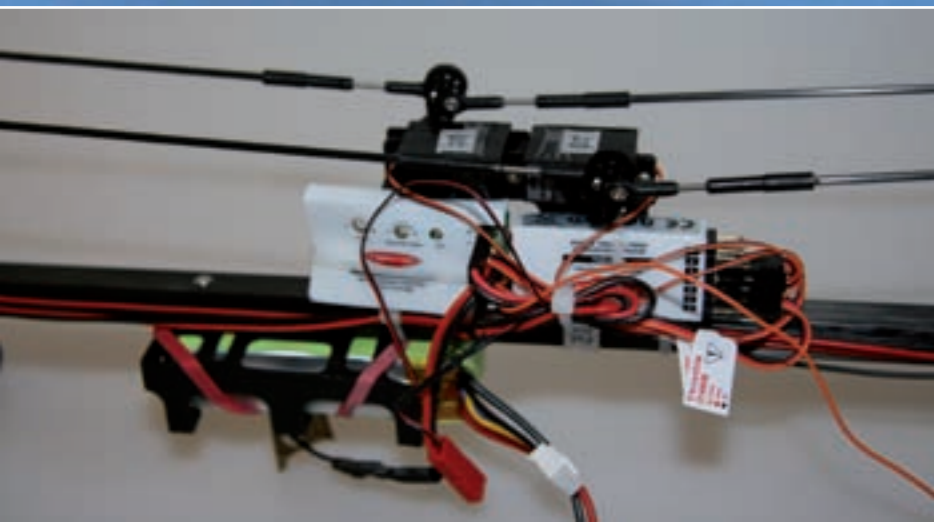
Die gesamte Technik wie Drei-in-eins-Einheit, Rudermaschinen und Akku sind Schwerpunktneutral im Mittelteil des Skylift an einem Technikträger montiert
