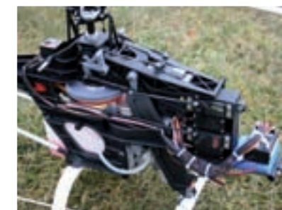
Die Servos sind schon vormontiert, die Leitungen sehr sauber verlegt
