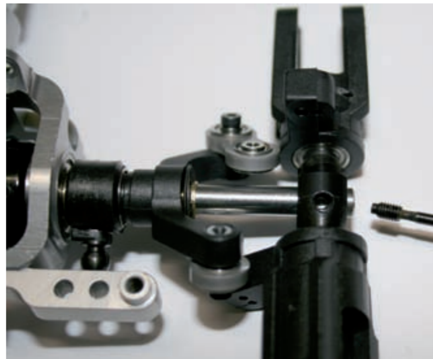
Die Heckrotornabe wird mit Inbusschrauben gesichert. Diese verfügen ihrerseits über eine Nase, die in die Heckrotorwelle greift. Die Hecksteuerbrücken-Verbinder sind edel aus Alu gefertigt und vierfach kugelgelagert
