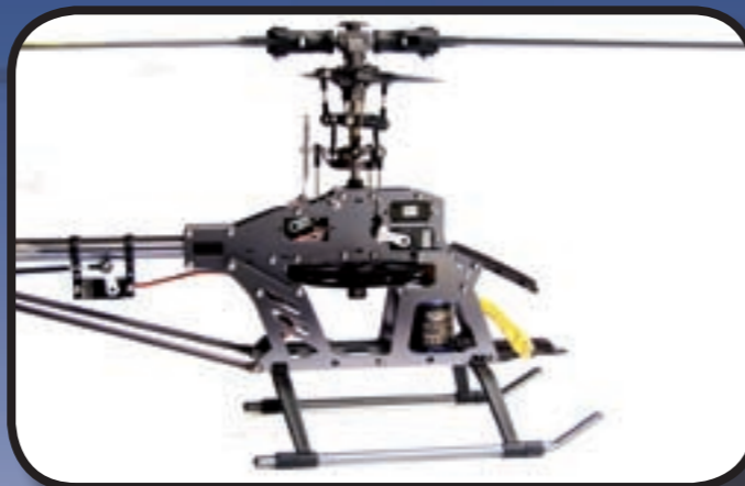
Chassis und Heckausleger sind aus Aluminium in hoch attraktiver Titan-Optik. Die vier digitalen Mikroservos der 9-Gramm-Klasse gehören zum Lieferumfang und sind bereits montiert
