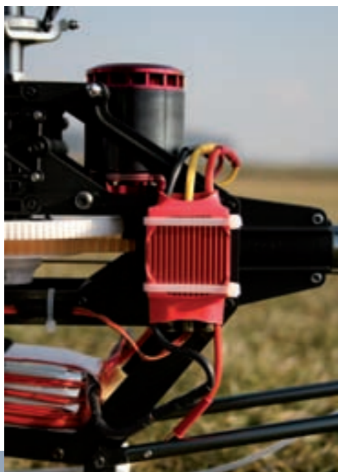
Der Motor, der Regler und der Stromanschluss vom Akku sitzen im Heckbereich des Helis. Damit ist die Elektronik im Vorderbereich bestens gegen Störungen abgesichert. Die Leitungen von Regler und Motor wurden etwas gekürzt
