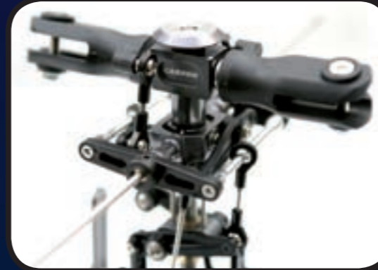
Rotorkopf-Zentralstück aus Alu, die Ansteuerung der Hillerpaddel erfolgt über einen spielfreien Rahmen
