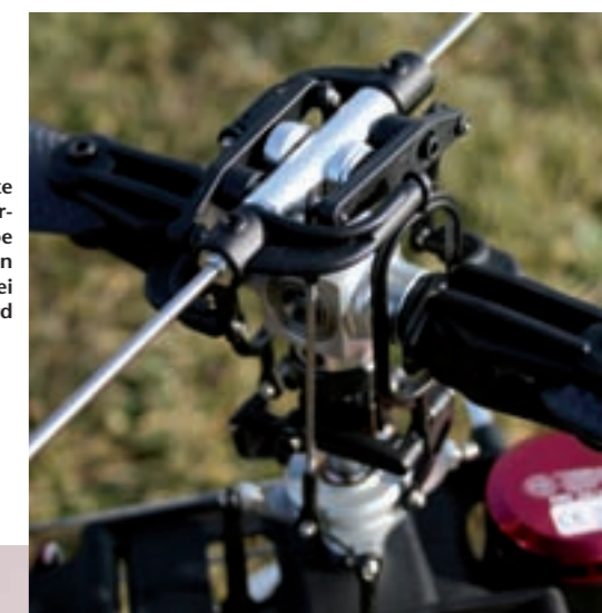
Diese Wege sind bei einer 140-Grad-Anlenkung gleich. Damit bewirken die Servoausschläge zu den vorderen und den beiden hinteren Ankerpunkten bei gleichem Stellweg einen symmetrischen Ausschlag der Taumelscheibe vorne und hinten
