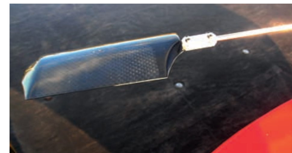
Hat sich sehr gut im F3C-Einsatz bewährt: Das K&S-F3C-Paddel aus Carbon. Es wiegt pro Stück etwa 40 Gramm und weiß durch ein ausgeglichenes Flugverhalten zu überzeugen
