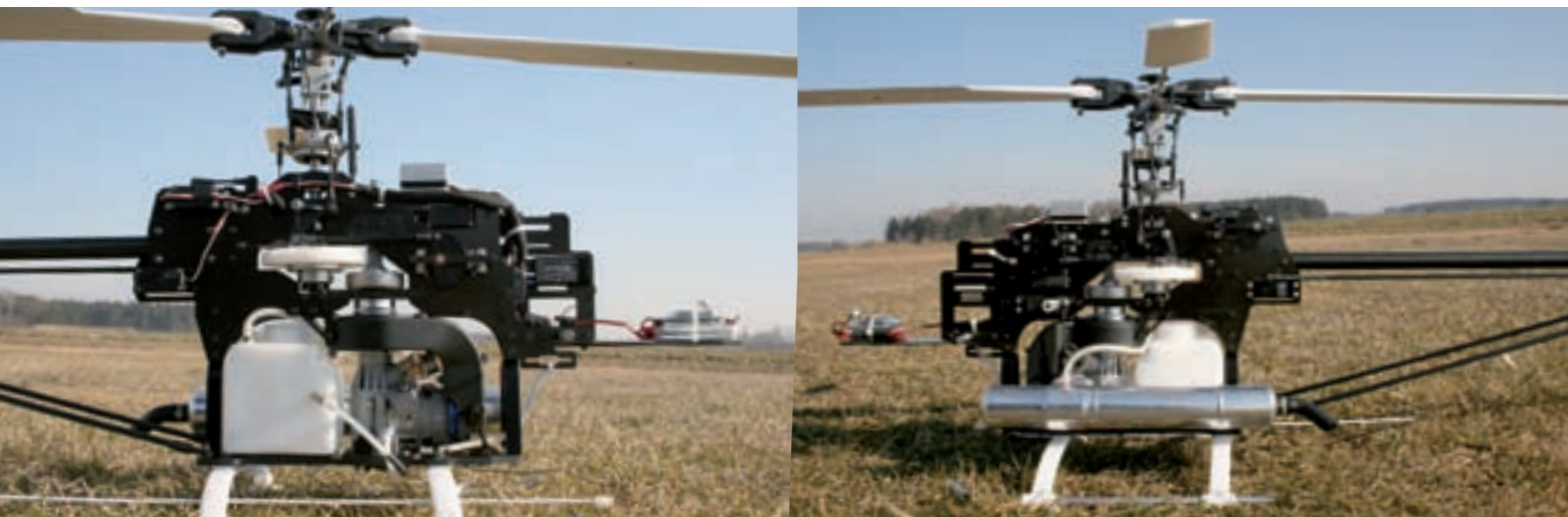
Die Anlenkung des Hecks erfolgt über ein CFK-Rohr, der Antrieb über einen Starrantrieb
