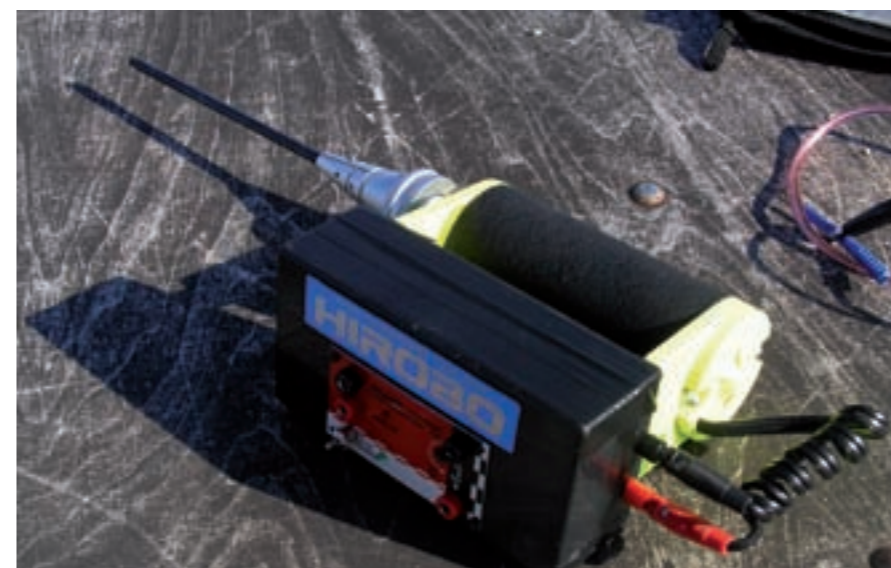
Hat sich im Wettbewerb bestens bewährt: ein Starter mit aufgesetzter Stromversorgung und integriertem Powerpanel. Da die Startvorbereitungen im Wettbewerb in einem extra abgegrenzten Bereich stattfinden, muss man nicht immer die komplette Startbox hin- und hertragen
