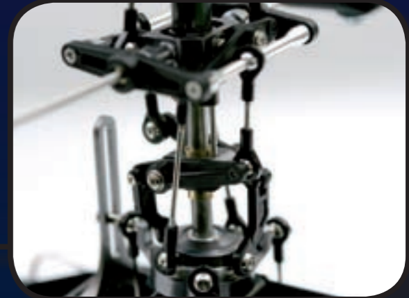
Taumelscheibe und Anlenkung des Pitchkompensators ebenfalls aus Alu
