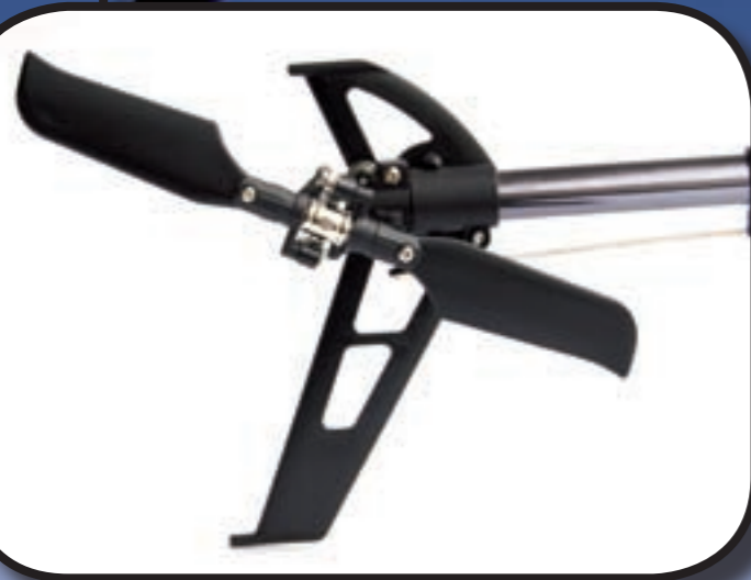
In Funktionalität und Optik sauber gemachter Heckrotor – der Antrieb erfolgt über einen Zahnriemen
