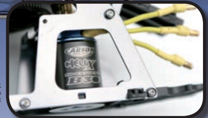
Der Brushlessmotor HeliX Shooter B30 ist bereits im Chassis montiert
