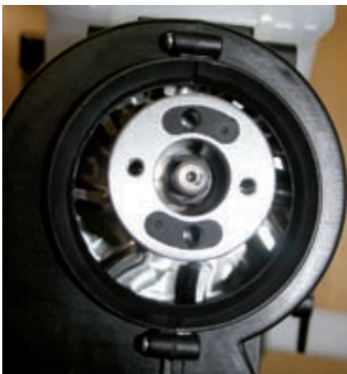
Das Lüfterrad leistet durch schräg stehende und aerodynamisch geformte Schaufelräder eine sehr gute Kühlung. Oben sind die beiden Löcher zu sehen, in die der Antrieb der Kupplung greift
