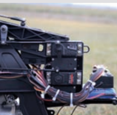
Die Gestänge sind bereits fertig abgelängt und an den Servos montiert
