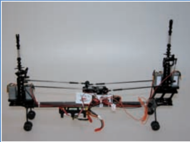
Unter der Rumpfhaube verbirgt sich eine ausgefeilte Technik. Insgesamt vier Elektromotoren verrichten hier ihre Arbeit
