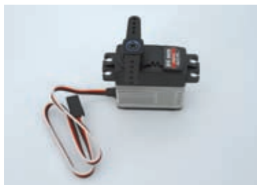
Hier ist das neue digitale Heckservo DS 0606 aus dem Hause Thunder Tiger zu sehen, das direkt an 6 Volt betrieben werden kann
