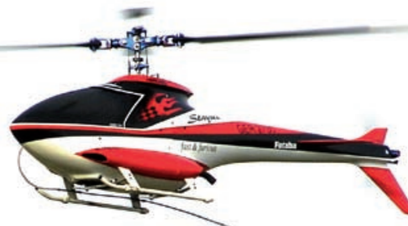
Eine der beiden Eagle 3 SWM mit Staysee-Verkleidung von FunTech. Mit Rumpfverkleidung hat das Modell eine bessere Aerodynamik für die Fahrfiguren, ist aber aufwändiger im Aufbau sowie der Wartung
