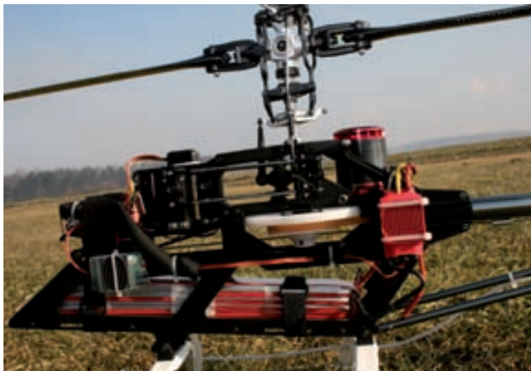
Am Servovorbau ist ein 6-Volt-Limiter mit einem Schalter befestigt. Unterhalb des Empfängers sitzt der LiPo-Akku mit 1.000 Milliamperestunden Kapazität
