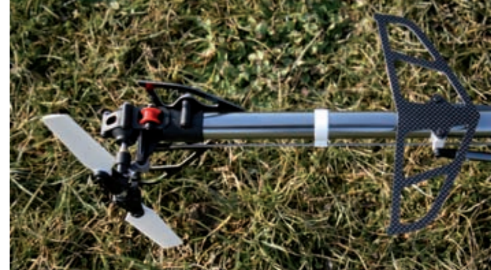
Die Heckleitwerke sind im Bausatz schon aus CFK, was Gewicht spart und geringen Luftwiderstand bietet
